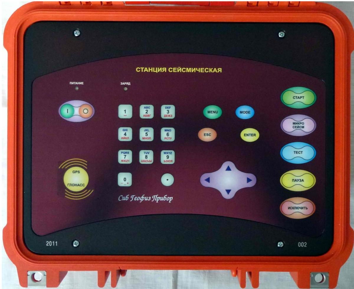
Рис. 3. Лицевая панель (клавиатура) модуля бортового SGD-SME/UA.
