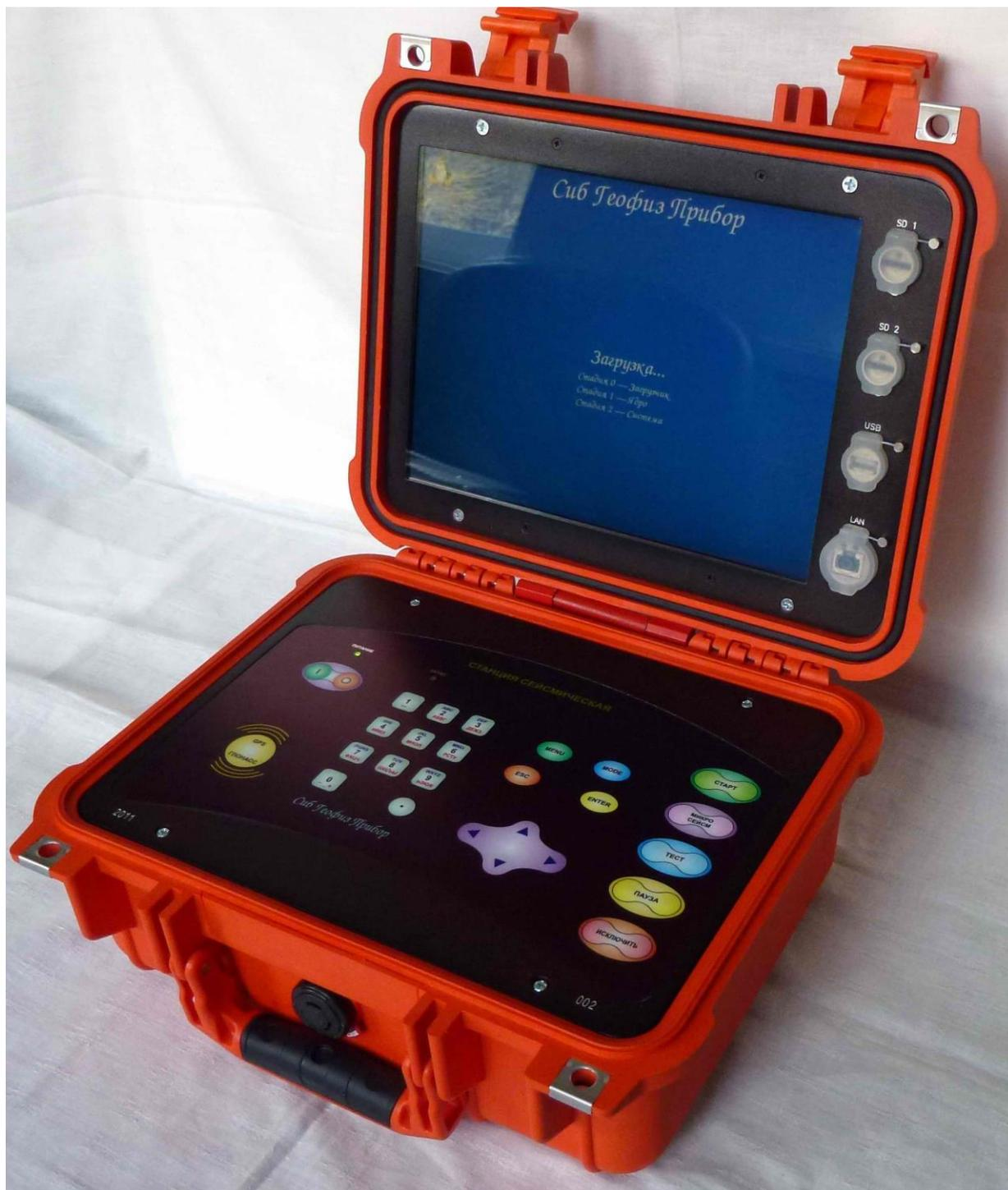
Рис. 2. Модуль бортовой SGD-SME/CUA.
