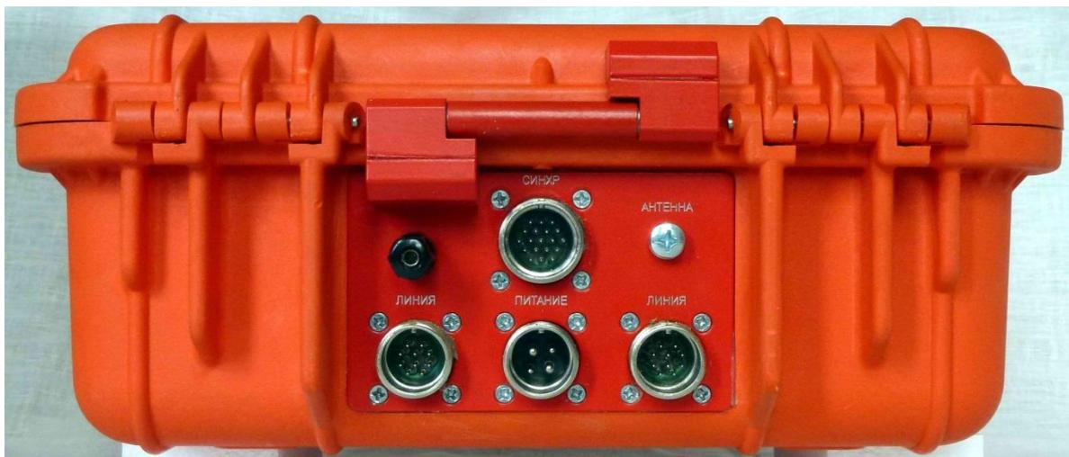
Рис. 4. Задняя панель (разъёмы) модуля бортового SGD-SME/UA.
